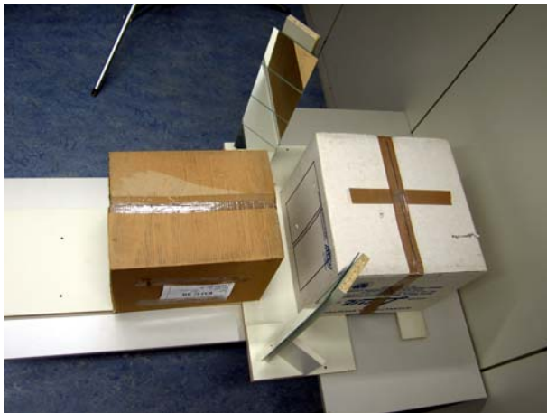
Abbildung 2: Im Labor wurde die Eignung von Spiegeln in vereinfachten Versuchen getestet und ein günstiger Strahlengang ermittelt.
