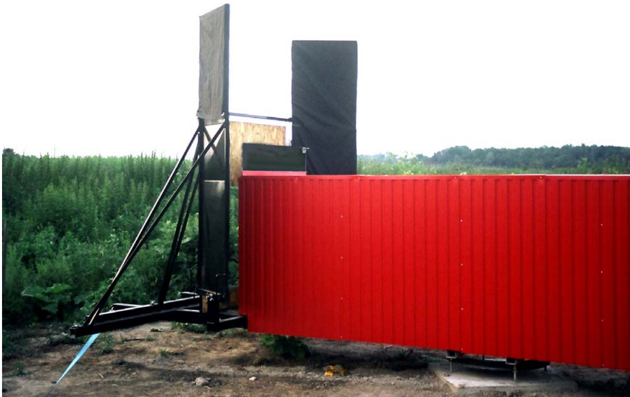
Abbildung 1: Ein neuer Versuchstunnel („Flugstunnel II“) in Hohenau-Ringelsdorf soll die Forschungen der Jahre 2004 und 2005 mit erweiterten Möglichkeiten fortführen und bessere Prognosen zur Wirksamkeit von vogelschlagmindernden Markierungen auf Glasflächen möglich machen. Flugstunnel II, hier nicht in Betrieb, Spiegel verhüllt.
