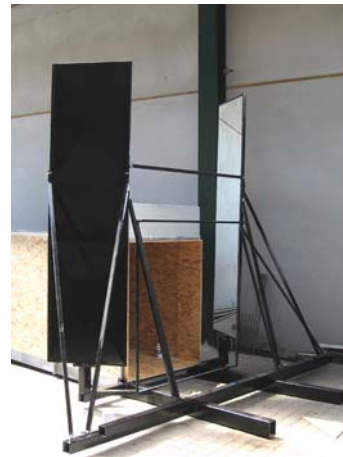
Abbildung 3: Vom Modell zur Verwirklichung: hier die Spiegel (0,65m x 2,50m) am fast fertiggestellten Versuchstunnel in der Werkshalle.
